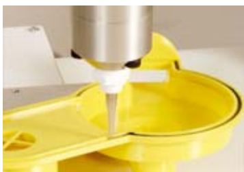
▲ TS941 Auftrag von Silikondichtung
