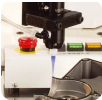
▲ TS5322 Auftrag einer Silikondichtung.
